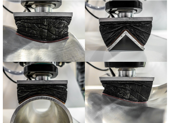
Flexible 3D Faserablage mit Fiber Patch Placement
